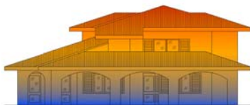
Distribuzione della temperatura con un sistema tradizionale
